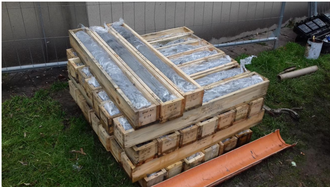
Fotografia 4 Zdjęcia pobranych i zabezpieczonych rdzeni wiertniczych.
